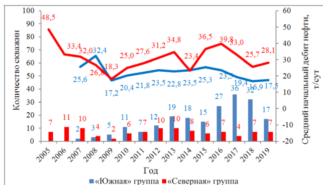
Рис. 5. Динамика средних начальных дебитов нефти новых горизонтальных скважин в карбонатном коллекторе, ранжированная по территориальной принадлежности
