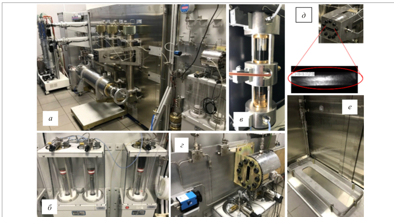
Рис. 2. Лабораторный комплекс для выполнения исследований тепловых и газовых МУН: а – общий вид установки, б – поршневые расходомеры, в – визуальный трехфазный сепаратор, г – блок измерения поверхностного натяжения в пластовых условиях, д – визуальная ячейка, е – слим-модель в термошкафу
