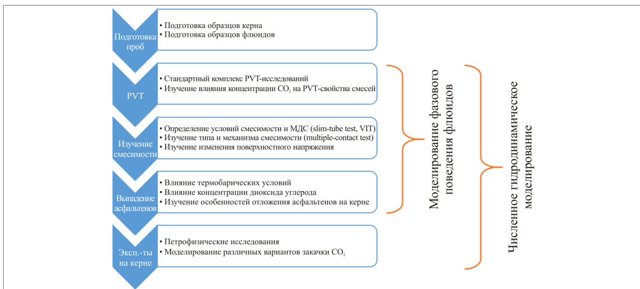
Рис. 1. Методология комплексных исследований методов увеличения нефтеотдачи, основанных на закачке диоксида углерода
