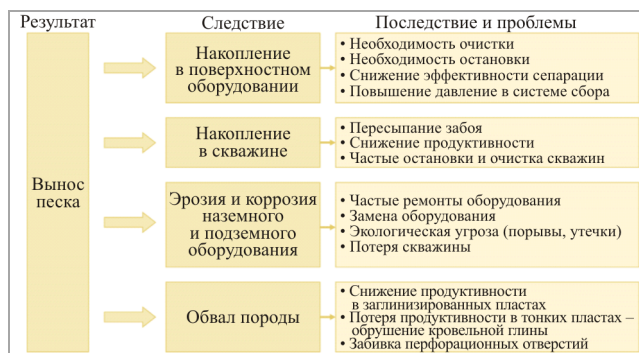
Рис. 3. Последствия выноса механических примесей
