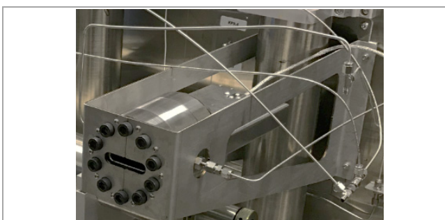
Рис. 3. Ячейка со смотровым окном для наблюдения за фазовым поведением флюидов
