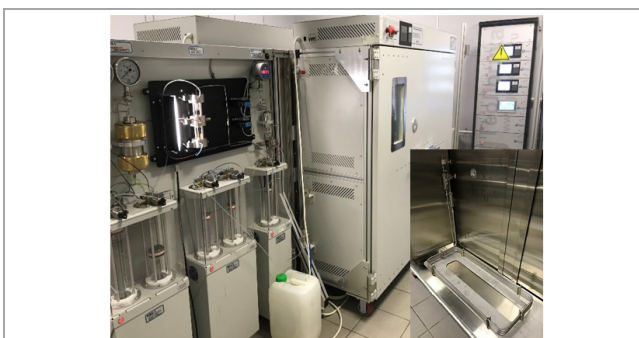
Рис. 2. Фотография трехфазной фильтрационной установки и «слим-модели» в термошкафу
