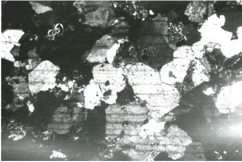
Рис. 11. Трансляционные линии скольжения и начало трещинообразования по ним. Боковое освещение. Увеличение 250 х
