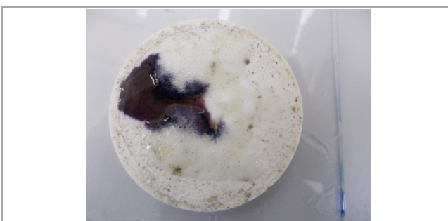
Рис. 4. Изменение цвета йодного раствора, свидетельствующее о наличии крахмала в фильтрационной корке
