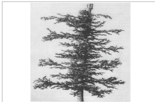
Рис. 2. Каналы после СКО в карбонатных образцах
