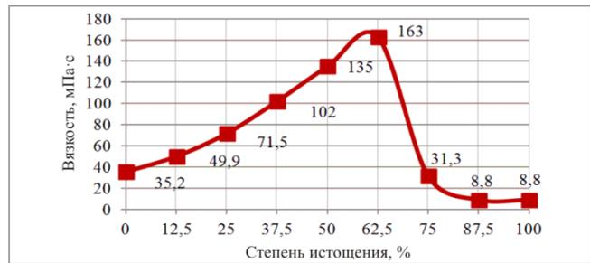
Рис. 1. Динамика вязкости СОКС при реакции с керновым материалом при пластовой температуре
