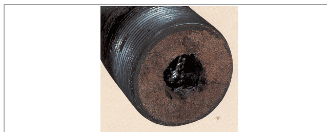
Рис. 1. Насосно-компрессорная труба с отложениями парафина на внутренней поверхности
