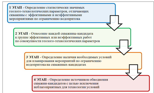
Рис. 1. Схема методического подхода по выбору скважин-кандидатов
