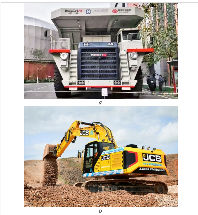
Рис. 5. Техника, работающая на водородном топливе: а – водородный карьерный самосвал CR240E компании CRRC Yongji; б – экскаватор JCB с приводом от водородных топливных элементов (по материалам [46])
