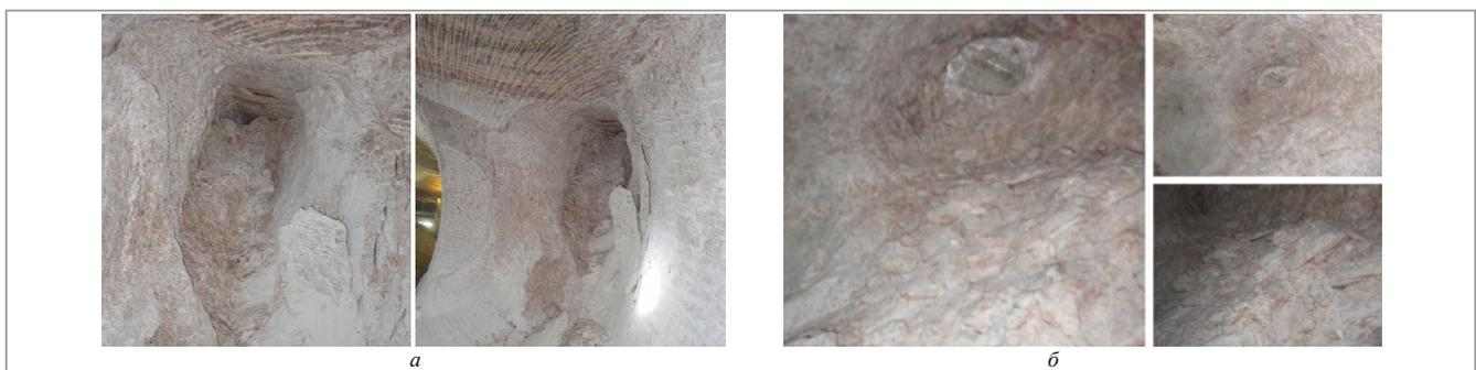
Рис. 3. Форма полости внезапного разрушения приконтурного массива: *а* – в стенке разведочного штрека № 2; *б* – в забое транспортного штрека № 1
