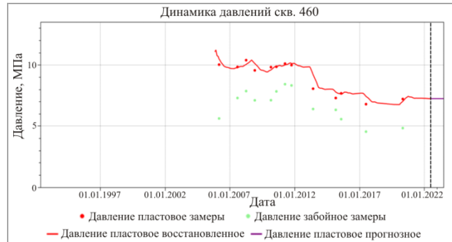
Рис. 3. Пример расчета P_{пл} скв. №460. Объект Т-Фм-Фр
