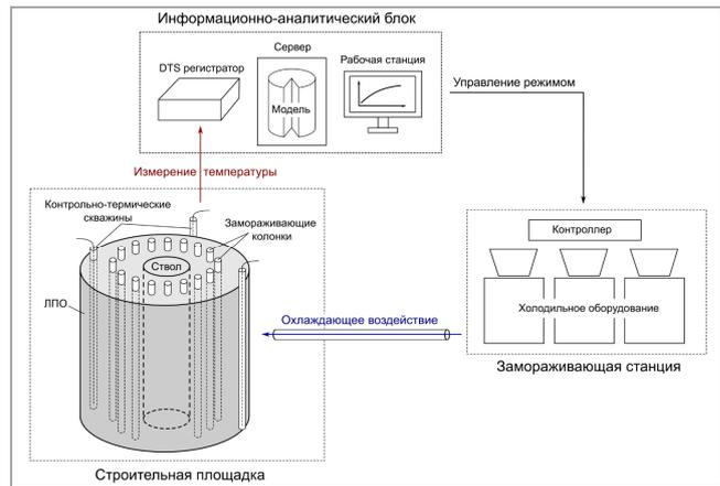
Рис. 1. Принципиальная схема системы термометрического контроля и управления искусственным замораживанием горных пород на участке строительства ствола
