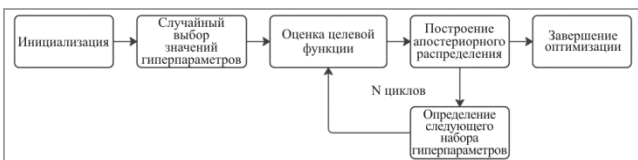
Рис. 5. Блок-схема алгоритма поиска оптимальных значений гиперпараметров
