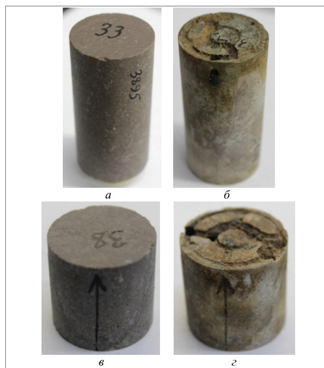
Рис. 2. «Длинный» (а, б) и стандартный (в, г) образцы керна до (а, в) и после (б, г) воздействия кислотным реагентом
