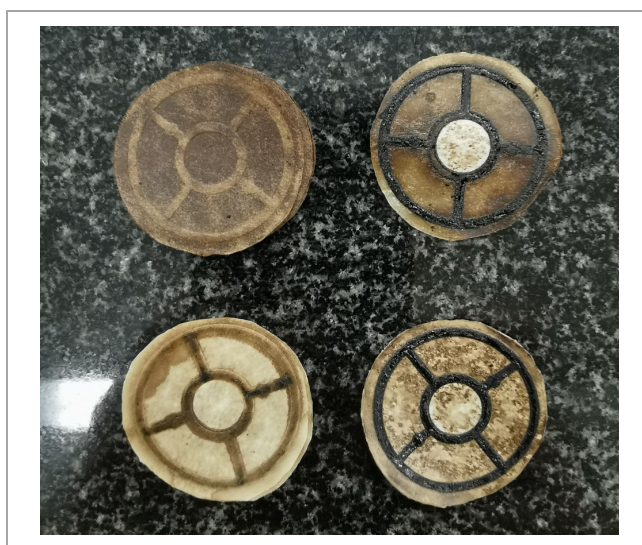
Рис. 7. Изображение бумажных фильтров на входе в керновую модель: слева – после K_{vt} ; справа – после ОФП; верхние – модель 2; нижние – модель 3
