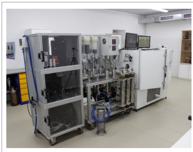
Рис. 2. Установка для моделирования технологий водогазового воздействия с целью повышения нефтеотдачи пластов
