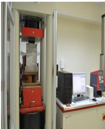
Рис. 2. Измерительный гидравлический 500т пресс Toni Norm
