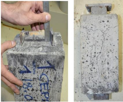
Рис. 4. Смещение жесткой арматуры, и характерные трещины в образцах
