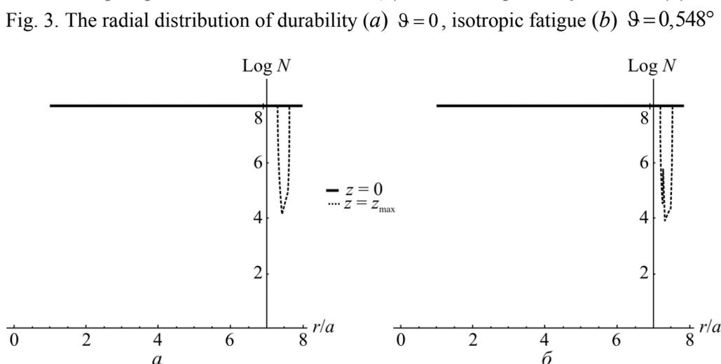
Рис. 4. Радиальное распределение долговечности (а)  $\vartheta = 0$ , анизотропная усталость (б)  $\vartheta = 0,548^\circ$ ,  $\varphi = 0^\circ$
