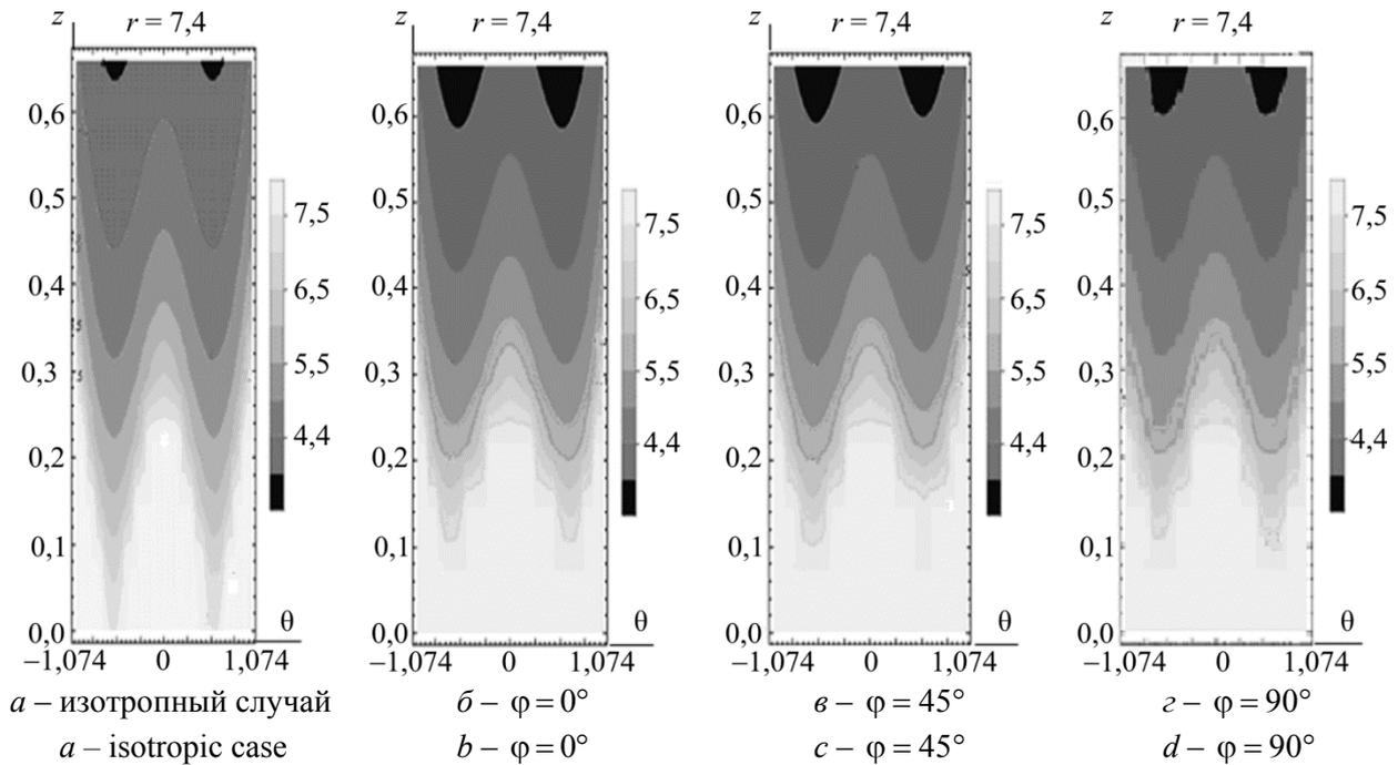
Рис. 7. Изополюсы долговечности в наиболее опасном сечении диска  $r = 7,4$ ,  $-1,074^\circ < \theta < 1,074^\circ$ ,  $0 < z < 0,7$ : изотропный (*a*) и анизотропные (*b–d*) случаи
