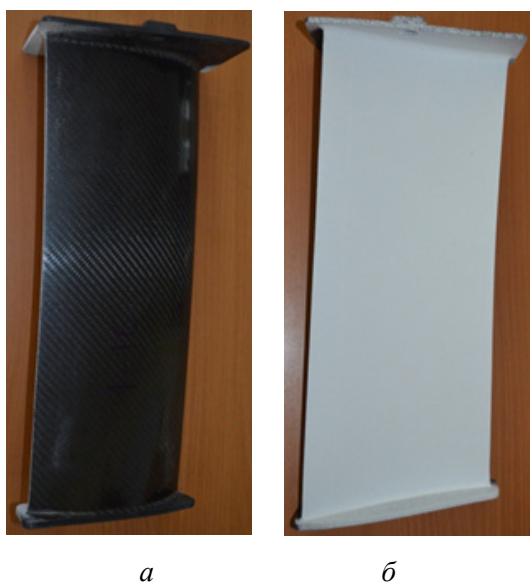
Рис. 1. Общий вид образца ЛСА из ПКМ в исходном состоянии (а) и с нанесенным покрытием для лазерного модального анализа (б)
