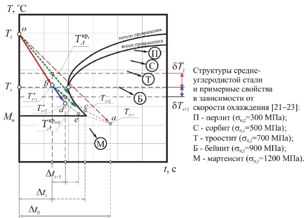
Рис. 4. Схема коррекции шагов временной сетки при совместном анализе разноскоростных процессов (термоструктурная задача) в области критических значений по термокинетической диаграмме ( T'_{i+1}, T'_{i+2} – уточненные значения температуры на i+1 и i+2 итерациях; \sigma_{0.2} – условный предел текучести материала в текущем структурном состоянии [21–23])
