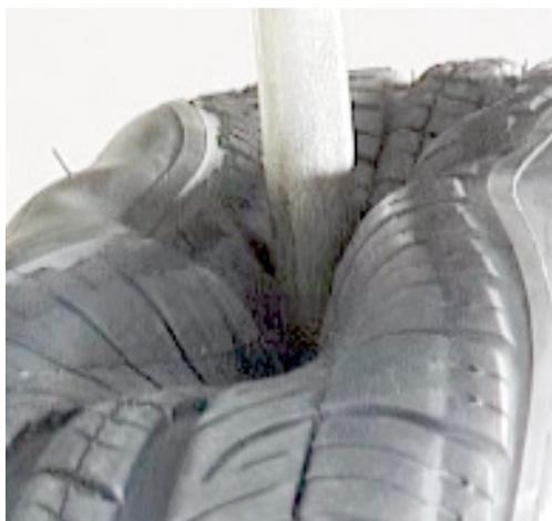
Рис. 1. Тест на разрыв. Процесс внедрения индентера в шину
