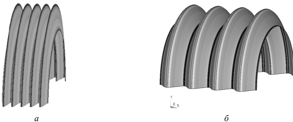
Рис. 1. Оболочка, развертывающаяся в «гофру»: а – начало развертывания внутренним давлением ( p = 10 Па); б – текущее состояние ( p = 15 кПа)
