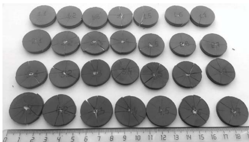
Рис. 4. Образцы после испытаний по схеме изгиба на кольцевой опоре
