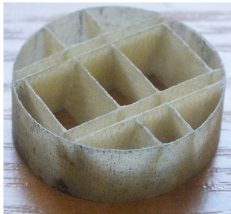
Рис. 2. Круглый образец однослойного ячеистого заполнителя для проведения акустических испытаний на интерферометре
