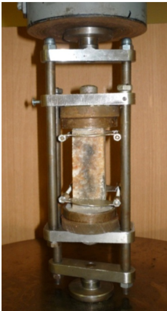
Рис. 1. Испытательное реверсивное устройство с подготовленным образцом
