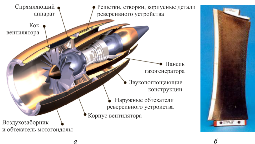
Рис. 1. Общая схема ТРДД (а) [1] и лопатка спрямяющего аппарата из углепластика (б) [4]
