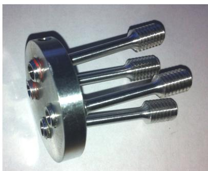
Рис. 1. Образцы для исследования на прочность, закрепленные на приспособлении
