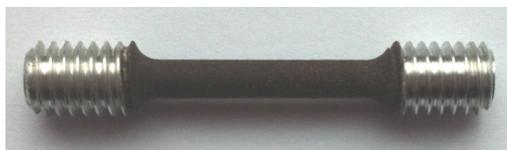
Рис. 3. Образец для исследования на прочность с МДО-слоем
