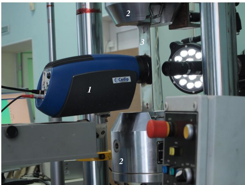
Рис. 2. Внешний вид экспериментальной установки: 1 – инфракрасная камера FLIR SC 5000; 2 – захваты сервогидравлической нагружающей машины Ви-00-100; 3 – исследуемый образец
