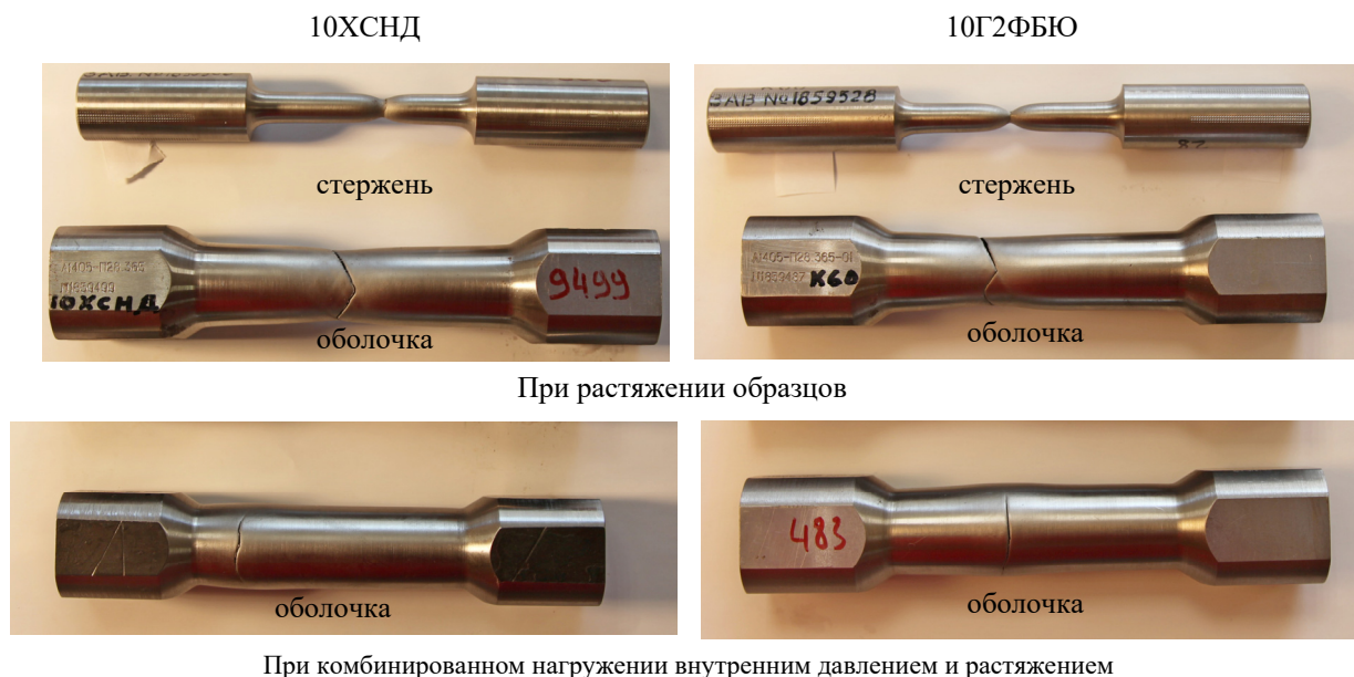
Рис. 4. Вид разрушения оболочек и стержней из сталей 10ХСНД и 10Г2ФБЮ при растяжении и комбинированном нагружении внутренним давлением и растяжением
