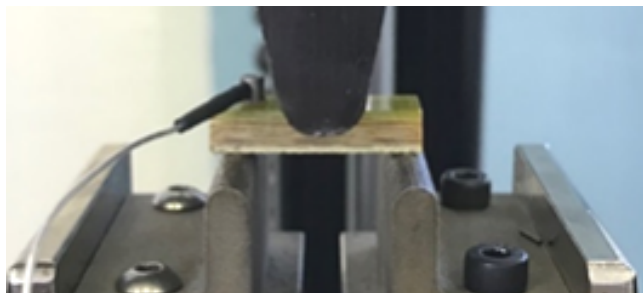
Рис. 1. Образец стеклопластика СТЭФ в оснастке для испытаний на межслоевой сдвиг с прикрепленным датчиком АЭ
