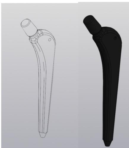
Рис. 4. Цифровая модель эндопротеза ТБС
