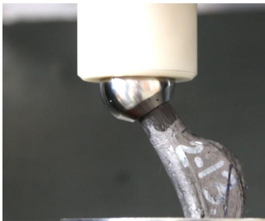
Рис. 1. Эксперимент по нагружению эндопротеза
