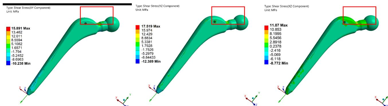
Рис. 13. Картины распределения касательных напряжений в конструкции эндопротеза ТБС, МПа
