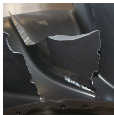
Рис. 13. Остатки рабочей лопатки после обрыва
