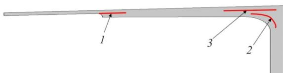
Рис. 4. Схема усталостных повреждений в образцах фланца
