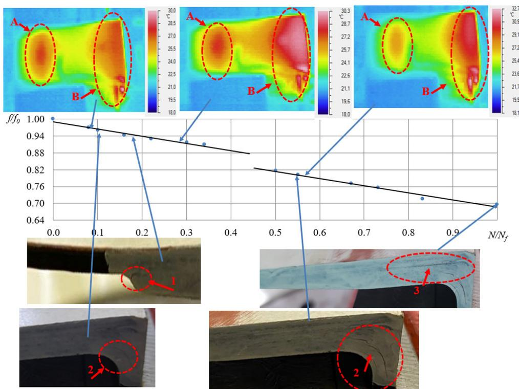
Рис. 7. Изменение относительной резонансной частоты колебаний образца с относительной усталостной наработкой, усталостные повреждения и поля температуры при различных значениях усталостной наработке
