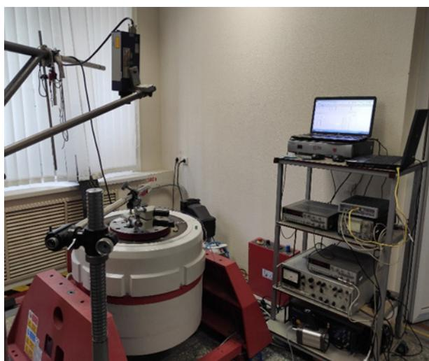
Рис. 3. Экспериментальная установка: схема (а) и внешний вид (б): 1 – исследуемый образец, 2 – крепежное приспособление, 3 – электродинамический вибратор, 4 – блок управления пневмосистемой, 5 – усилитель мощности, 6 – микроскоп, 7 – сенсорная головка лазерного виброметра, 8 – прецизионная инфракрасная камера, 9 – лазерный виброметр, 10 – регулятор мощности, 11 – частотомер, 12 – счетчик циклов, 13 – осциллограф, 14 – компьютер, 15 – акселерометр, 16 – тензостанция
