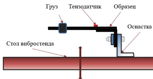
Рис. 2. Схема нагружения образца при усталостных испытаниях
