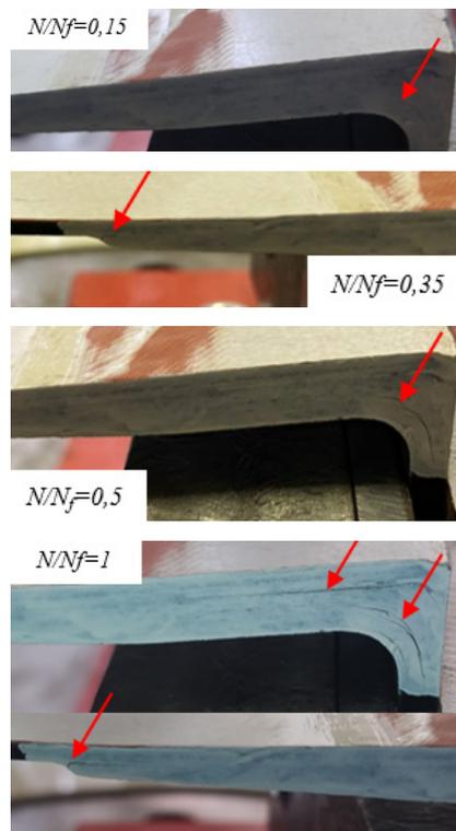
Рис. 5. Пример процесса развития усталостного повреждения в образцах фланца при различных значениях усталостной наработки
