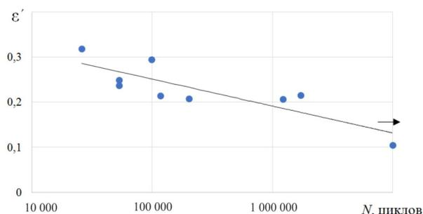
Рис. 6. Кривая усталости фланца:  $\epsilon' = \epsilon_a / \epsilon_{st}$ , где  $\epsilon_{st}$  — предельная деформация при статических испытаниях материала
