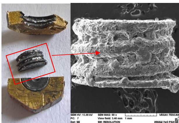
Рис. 5. Образец детали с винтовой резьбой из B95/10% SiC, полученный в нестационарных термомеханических условиях Fig. 5. A sample of a part with a screw thread made of V95/10% SiC obtained in non-stationary thermomechanical conditions
