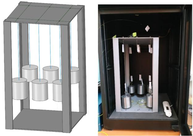
Рис. 1. Схема оснастки с оптическими волокнами и грузами и вид оснастки, помещенной в экспериментальную установку
