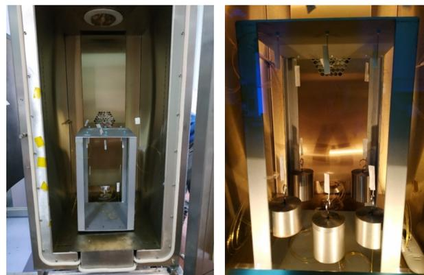
Рис. 4. Экспериментальная установка для длительного испытания ВОДД при постоянном уровне температуры
