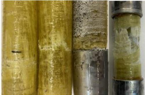
Рис. 2. Фотографии разрушенных образцов (слева направо): без предварительной подготовки захватной части; с наждачной бумагой; с алюминиевыми гильзами, толщина стенки менее 1 мм; с алюминиевыми гильзами, толщина стенки  $\approx 1,5$  мм
