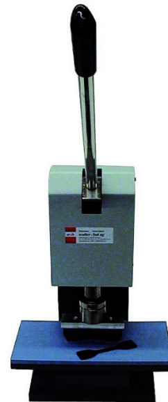
Рис. 1. Вырубной пресс для формирования образцов из заготовок пленок и пластин
