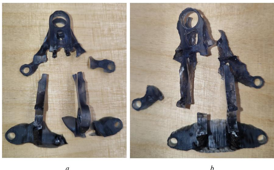
Рис. 9. Формы разрушения оптимизированного кронштейна Solidworks (a) и ANSYS (b)
