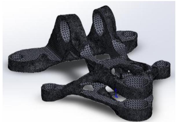
Рис. 3. Конечно-элементная модель оптимизированной детали
