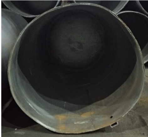
Рис. 1. Муфель в горизонтальном положении с остаточными деформациями
