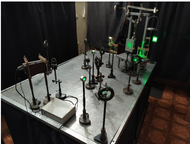
Рис. 1. Оптическая схема рабочей голографической установки: 1 – лазер; 2 – полупрозрачные зеркала; 3 – фазовые пластинки ( \lambda/2 ); 4 – зеркала; 5 – коллиматор; 6 – образец; 7 – фотопластинка
