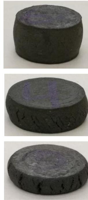
Рис. 2. Образцы из ЖНС после осадки
