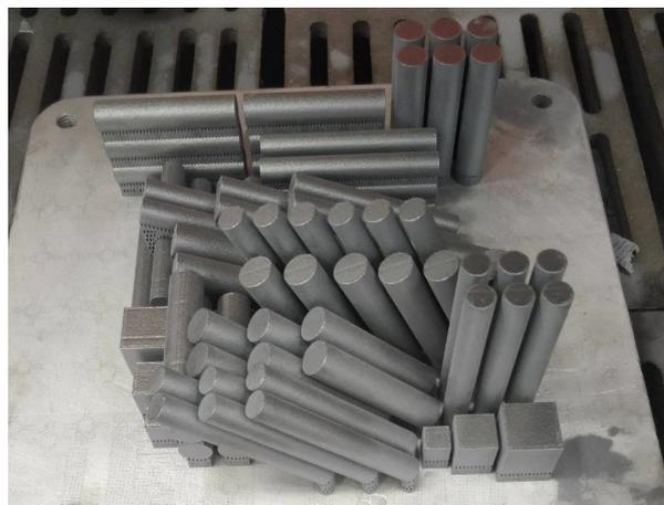
Рис. 1. Выращенные методом селективного лазерного сплавления заготовки под образцы в направлениях 0, 30, 45, 60 и 90° к плоскости наплавки и кубические образцы для микроструктурного анализа
