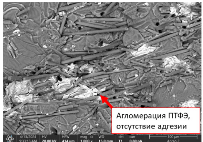
Рис. 1. Фрактографические изображения поверхности усталостного разрушения: a – ПЭИ; b – композит ПЭИ/КУВ; c – композит ПЭИ/КУВ/ПТФЭ
