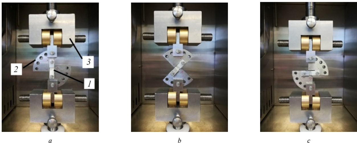
Рис. 2. Модифицированные образцы Аркана со вставками из клеевых соединений для определения адгезионной прочности при растяжении со сдвигом (1 – образец, 2 – пластины с отверстиями, 3 – зажимы испытательной машины). Угол \alpha между осью растяжения и плоскостью соединения: а – 0°; б – 45°; с – 90°
