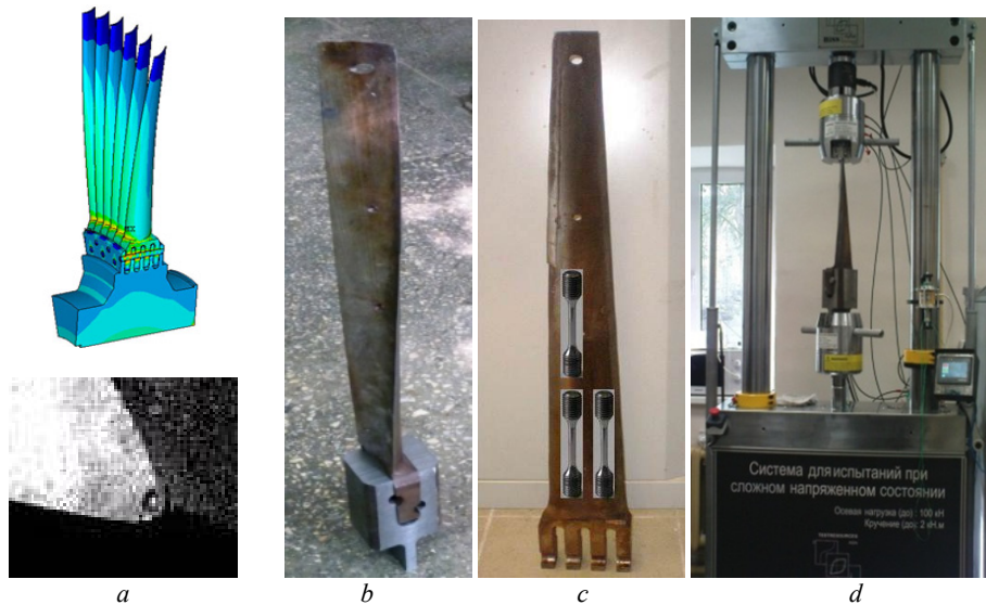
Рис. 23. Пора ( a ) на передней кромке лопатки ( b, c ) и установка для испытаний ( d ) при совместном растяжении с кручением
