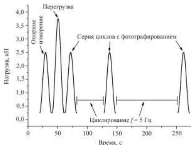
Рис. 15. Схема нагружения для испытания с единичной перегрузкой. Параметры базового цикла P_{\max}=2,5 кН, P_{\min}=0,28 кН, асимметрия R=0,1 . Цикл перегрузки P_{OVL}=3,75 кН. Длина трещины a=14,5 мм. Коэффициенты интенсивности K_{\max}=12,86 МПа \sqrt{м} , K_{\min}=1,29 МПа \sqrt{м} , K_{OVL}=19,3 МПа \sqrt{м}
