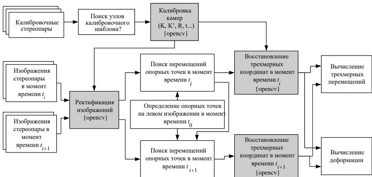
Рис. 2. Алгоритм работы системы технического стереозрения
