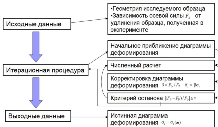
Рис. 1. Процедура методики построения истинных диаграмм деформирования в экспериментах на растяжение
