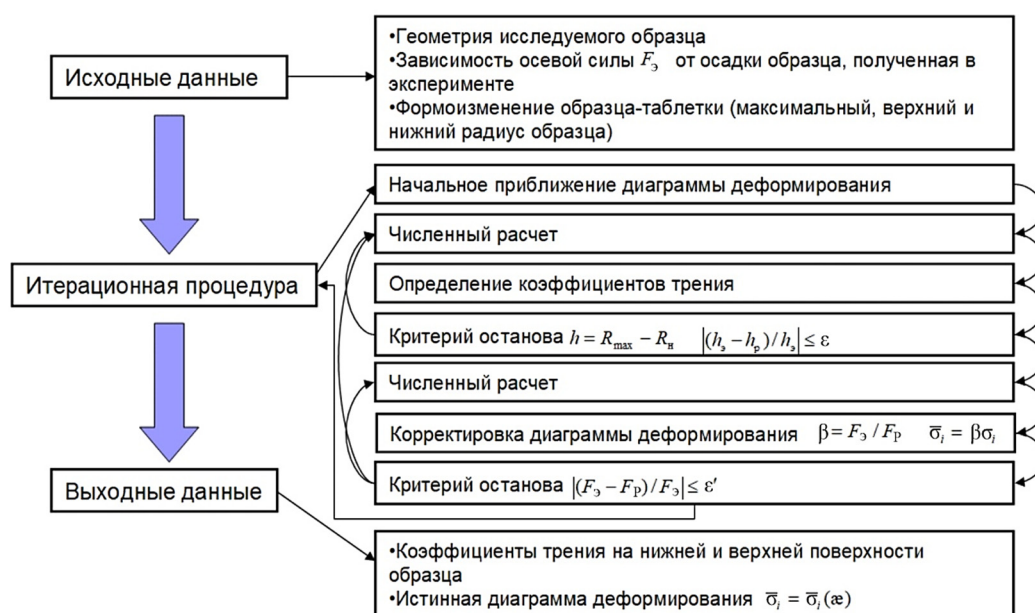
Рис. 2. Процедура методики построения истинных диаграмм деформирования в экспериментах на сжатие
