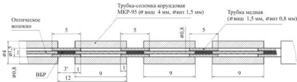
Рис. 2. Модель волоконно-оптической линии температурных датчиков
