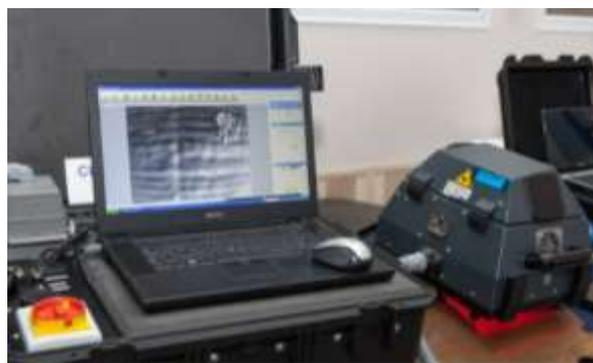
Рис. 5. Система шерографии Steinbichler ISIS mobile 3100 при проведении исследования
