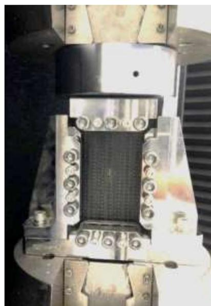
Рис. 8. Фото зажимного приспособления для испытания на остаточную прочность при сжатии с установленным образцом
